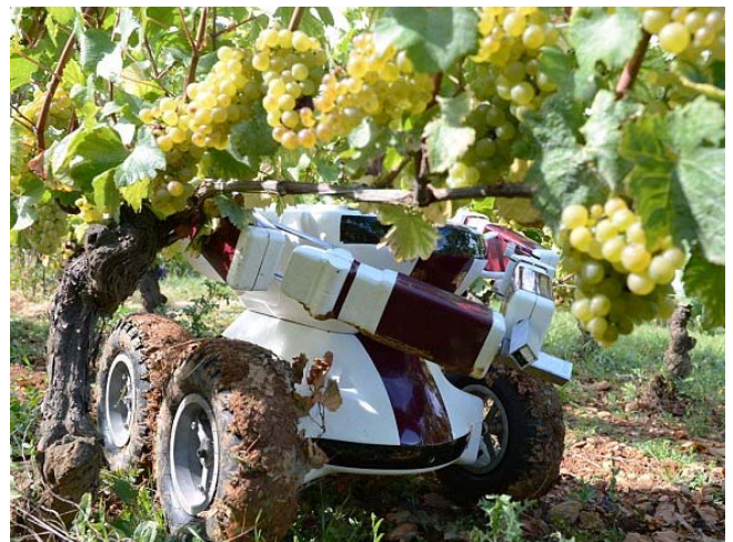
Slika 6.: Wall-Ye, avtonomni robot za trganje grozdja, Francija
